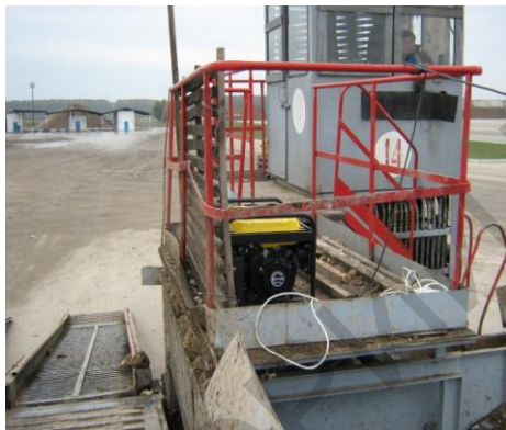
Рисунок 6 – Переносная электрическая станция
