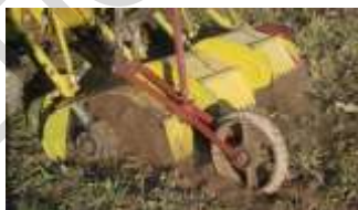
Рисунок 1 – Обработка почвы под полосный подсев трав в дернину опытным образцом машины
