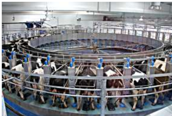
Рисунок 1– Доильная установка «Карусель» («Унибокс»)
