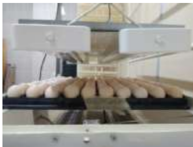
Рисунок 1 – Установка для дезинфекции инкубационных яиц ультрафиолетовым излучением С-спектра на основе четырех облучателей ОБН-01-2х55-013, укомплектованных бактерицидными TUV-лампами Philips мощностью 55W, в инкубатории филиала «Скидельская птицефабрика» ОАО «Агрокомбинат «Скидельский»
