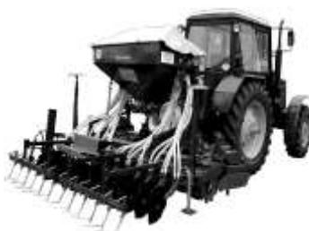
**Рисунок 2 – Агрегат комбинированный посевной АПП-3А**
