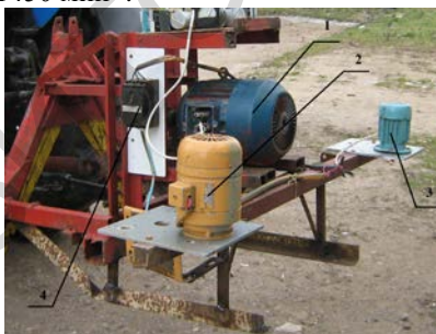
1 – асинхронный генератор; 2, 3 – электродвигатели; 4 – пускатель
