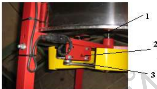
1 – вал ротора; 2 – электродвигатель; 3 – клиноременная передача
