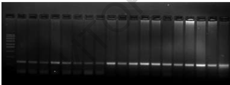
Рисунок 1 – Электрофореграмма технического результата предложенного способа идентификации мутации гена MSTN, ассоциированного с мясной продуктивностью крупного рогатого скота на основе ПЦР-анализа
