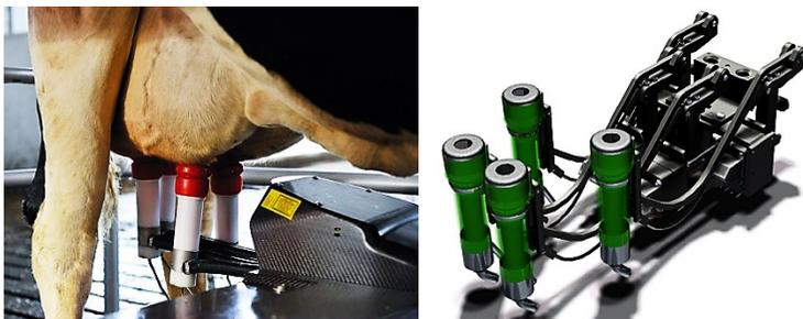
Рис. 5.14 - Роботизированный манипулятор систем Astronaut A4 и Mlone
