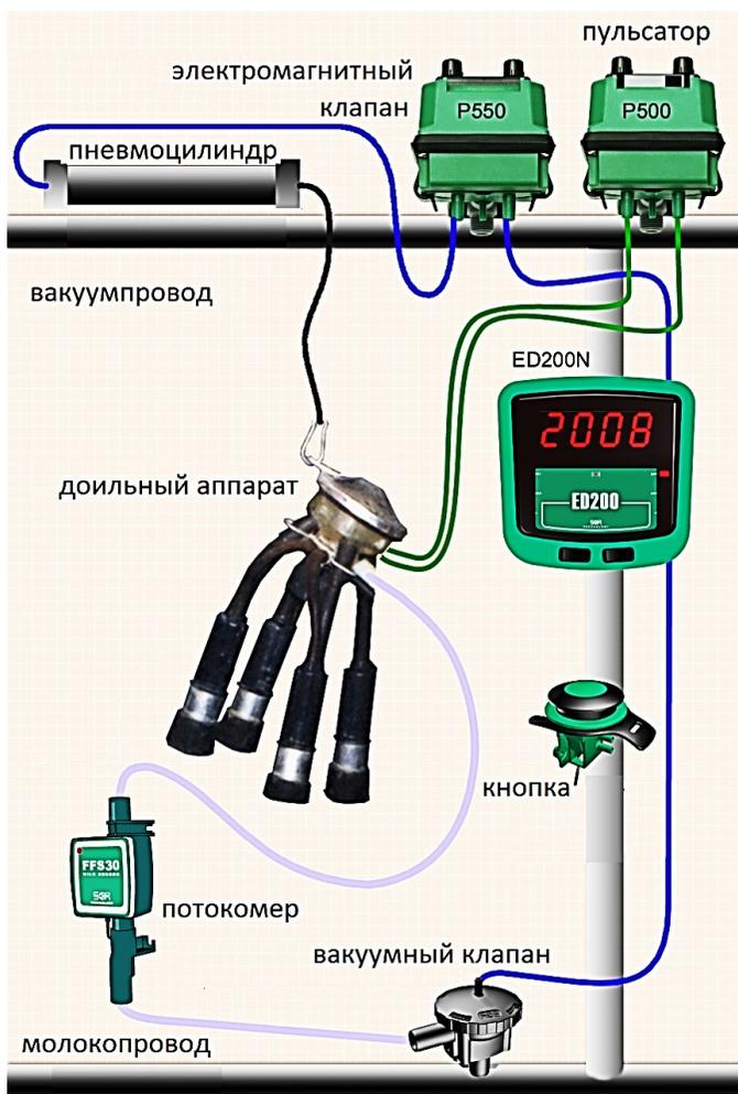
Рис. 5.3 - Схема управление оборудованием доильного поста
