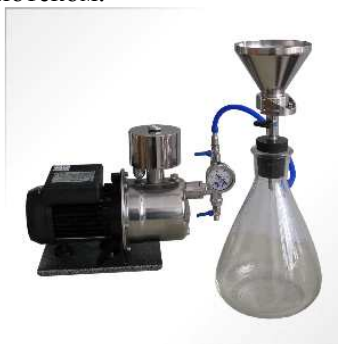
Рисунок 26. Система с колбой Бунзена для вакуумной фильтрации содержимого рубца
