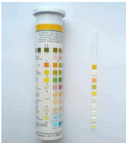
Рисунок 24. Тест-полоска с зонами индикации (справа) и пенал с эталонами (слева).
