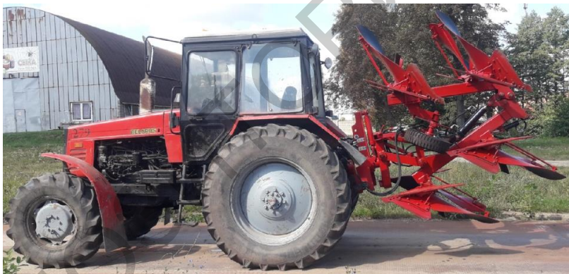
Рисунок 2 – Плуг ПОНС-4-40 в транспортном положении
