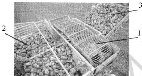
1 – циркуляционный элеватор; 2 – бункер; 3 – выгрузной транспортер
