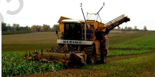
1 – протравочная камера; 2 – модуль дозирования раствора МДР-3.5
