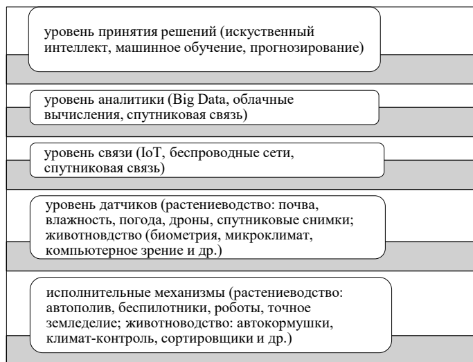
Рисунок 2 – Система управления в сельском хозяйстве на базе цифрового двойника
