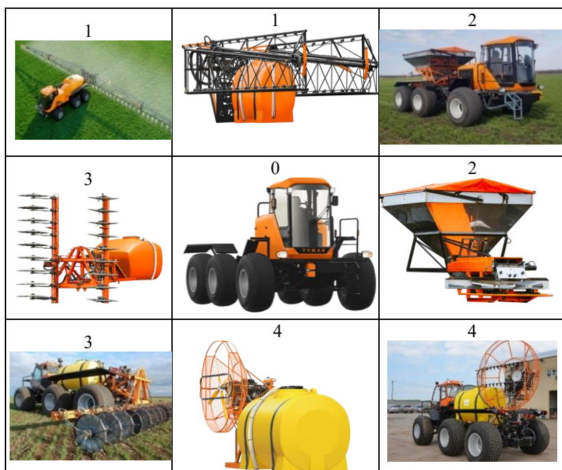
0 – шасси комплекса; 1 – штанговый опрыскиватель; 2 – разбрасыватель; 3 – мульти-инжектор; 4 – вентиляторный опрыскиватель
