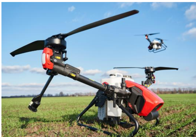
Рисунок 1 – Агродрон для опрыскивания сельскохозяйственных культур XAG V40
